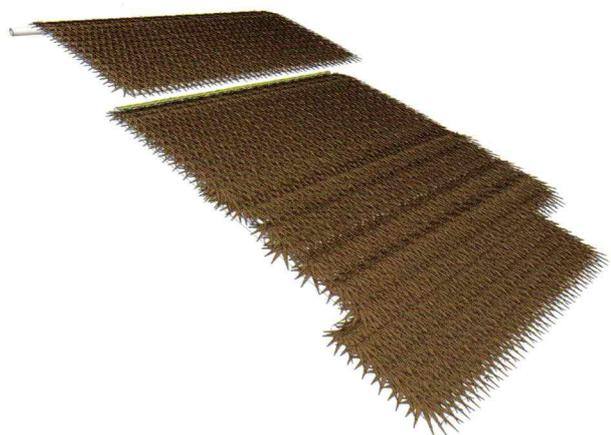
Hay que realizar un trabajo meticuloso en el montaje de las pencas de "yarey" para lograr la máxima estanqueidad posible, sobre todo, cuando las pendientes son de reducida inclinación.
